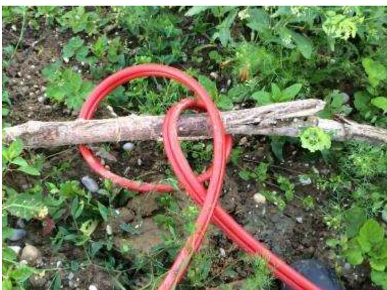
das sollte vermieden werden – ein Hydraulikschlauch wickelt sich um einen Ast
