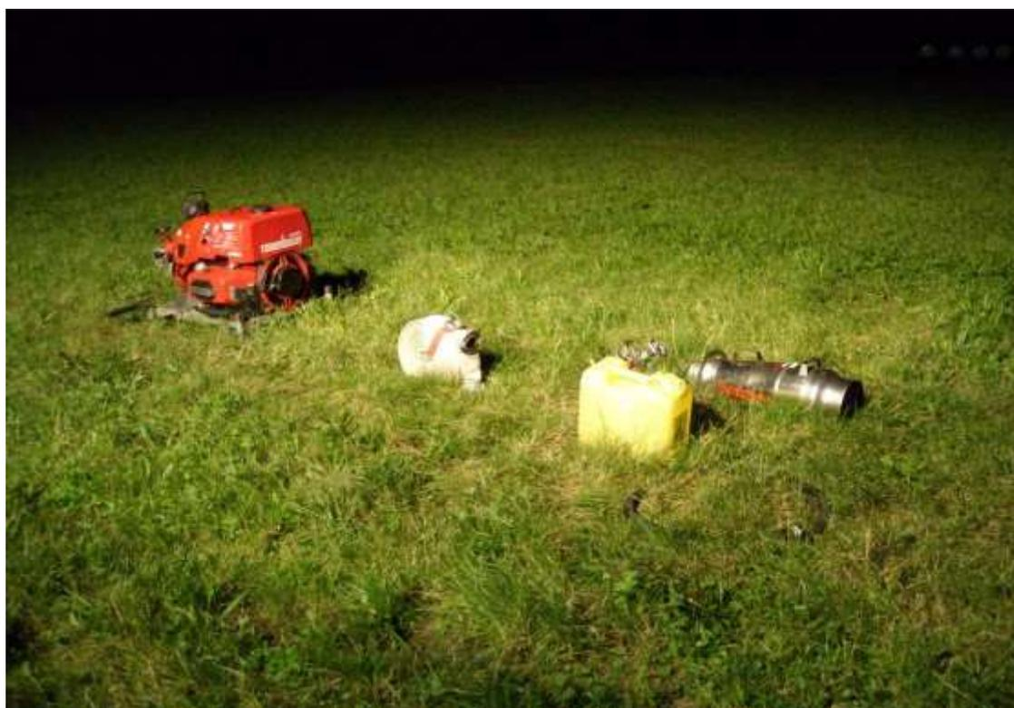
alles liegt bereit – TS, B-Schlauch, Schaummittel, Verteiler, Schaumrohr
