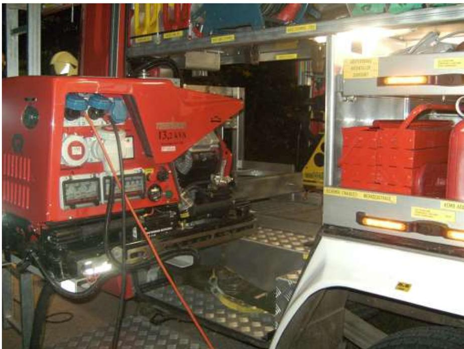
das Aggregat speist den Lichtmast mit Energie
